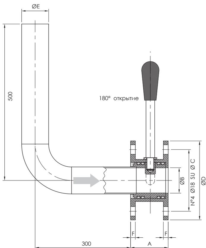
ДЕКАНТАТОР 90° ГАЙКА-РЕЗЬБА
