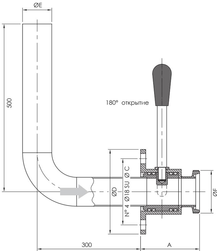
**ДЕКАНТАТОР 90° ФЛАНЕЦ-ФЛАНЕЦ КВАДРАТНЫЙ**
